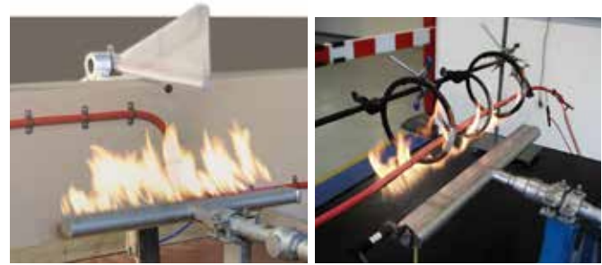
IEC 60331-21 Standardtest. EN 50200 og IEC 60331-2 Slagtest.
